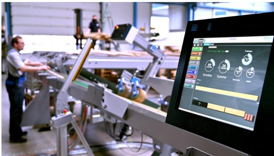
CNC-Steuerung der Kapsäge: Das gesamte System ist über ein Terminal komfortabel bedienbar (Bild: Paul Maschinenfabrik).
