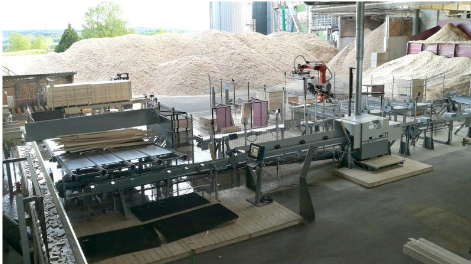
Die neue Anlage zur Optimierung des Werkstoffs Holz beinhaltet eine Kappsäge (vorn) und einen Stapelroboter (hinten) (Bild: Paul Maschinenfabrik).
