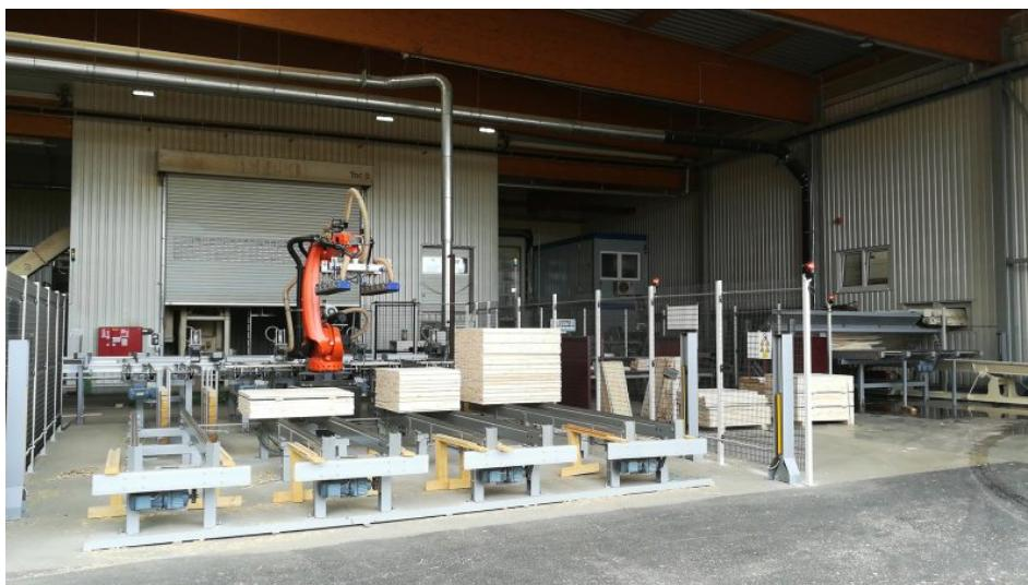
Stapelroboter mit Pufferplätzen für fertige Holzstapel (Bild: Paul Maschinenfabrik).
