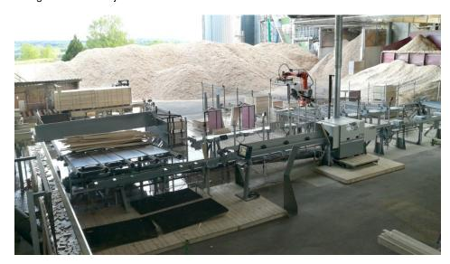
Die neue Anlage zur Optimierung des Werkstoffs Holz beinhaltet eine Kappsäge (vorn) und einen Stapelroboter (hinten) (Bild: Paul Maschinenfabrik).
