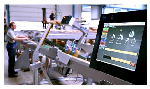
CNC-Steuerung der Kappsäge: Das gesamte System ist über ein Terminal komfortabel bedienbar (Bild: Paul Maschinenfabrik).
