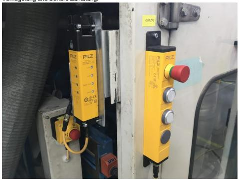
Mit der Taster-Unit und dem Schütztürsystem wird die Gefahrenzone der Parkett-Fräsmaschine abgeriegelt – allerdings in umgekehrter Richtung (Bild: Pilz).
