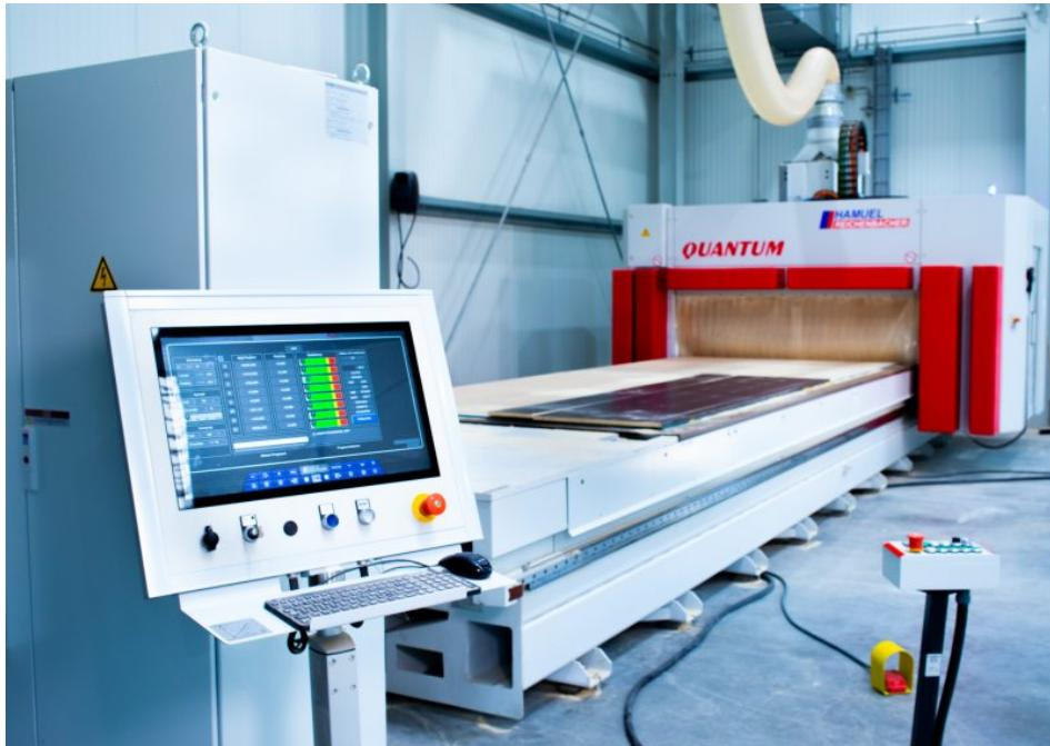
Das offene CNC-Steuerungssystem erlaubt es Maschinenbauern, eigene und kundenspezifische Bedienoberflächen zu integrieren (Bild: Siemens).
