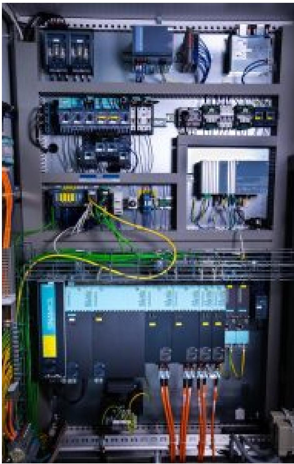
Die flexible Kombination von »Sinamics S210«- und »S120«-Antrieben sowie »Simotics 1FK2«- und »1FK7«-Motoren an der »Sinumerik MC«-Steuerung ermöglicht passgenaue Maschinenlösungen (Bild: Siemens).
