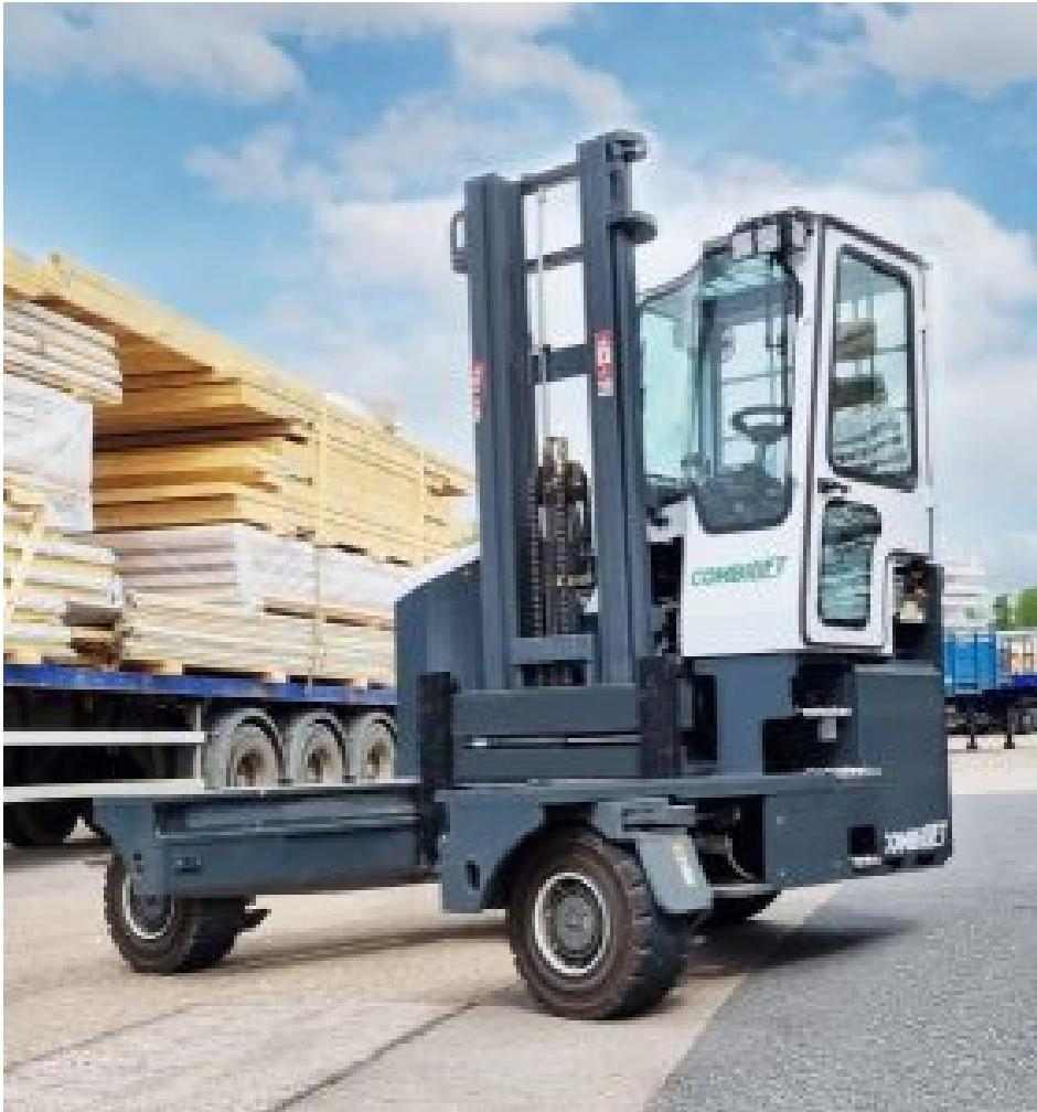
Verlässt das Fahrpersonal die Kabine, wird automatisch die Zündung deaktiviert (Bild: Combilift).
