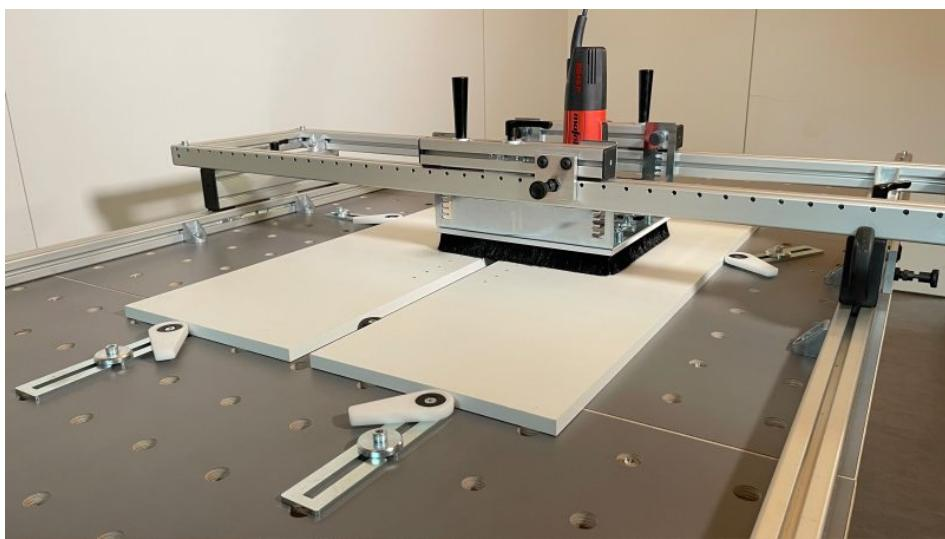
Das Fräsen von 32-Millimeter-Lochreihen ist dank der entsprechenden Lochraster-Führungsschienen besonders einfach (Bild: sauter).
