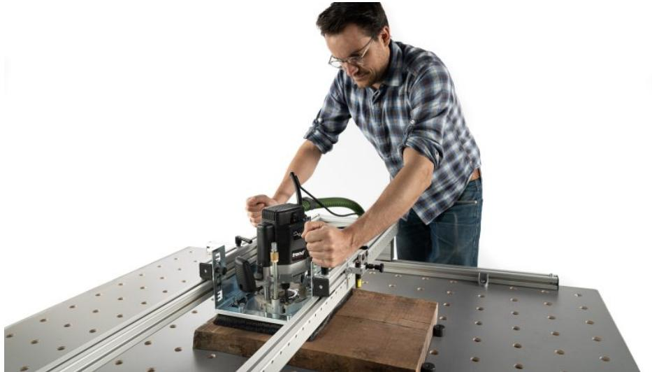
Durch das gezielte Setzen von Anschlagpins lassen sich zum Beispiel Taschen im gewünschten Format ausfräsen (Bild: sauter).
