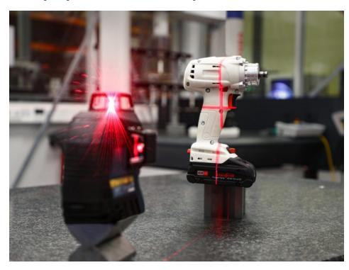
In Labor- und Anwendungstests wurde der Maschinenschwerpunkt analysiert, um die bestmögliche Balance zu ermitteln. Das Austarieren von Balance, Griffpositionen und Gewicht bezeichnet Mafell als »ErgoBanlanceKonzept« (Bild: Mafell).
