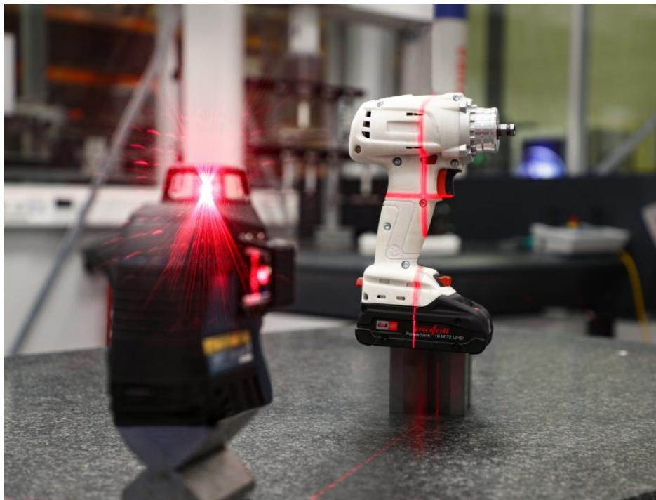
In Labor- und Anwendungstests wurde der Maschinenschwerpunkt analysiert, um die bestmögliche Balance zu ermitteln. Das Austarieren von Balance, Griffpositionen und Gewicht bezeichnet Mafell als »ErgoBalanceKonzept« (Bild: Mafell).
