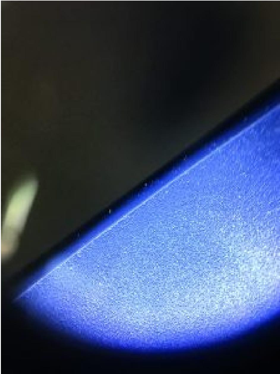
Mit der Lupe wird die Qualität bei Leicht Küchen geprüft. Sie zeigt einen absolut sauberen Übergang von Kante zur Platte ohne Mikrorisse (Bild: Leuco).
