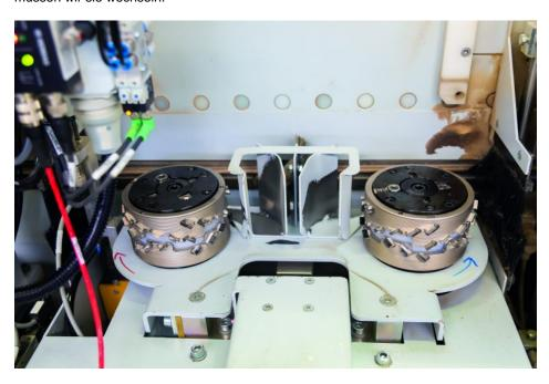
Ein weiterer Vorteil zeigt sich bei einem Konzept mit zwei Werkzeugen im Wechselfräsen: Der Fügefräser im Gegenlauf mit weniger Laufmetern und weniger Abnutzung muss weniger häufig nachgestellt werden (Bild: Leuco).
