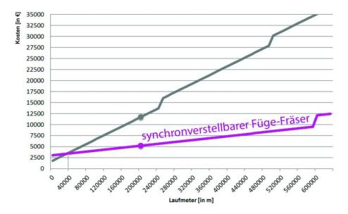
Das Werkzeug rechnet sich bereits ab 40.000 Laufmetern (Bild: Leuco).
