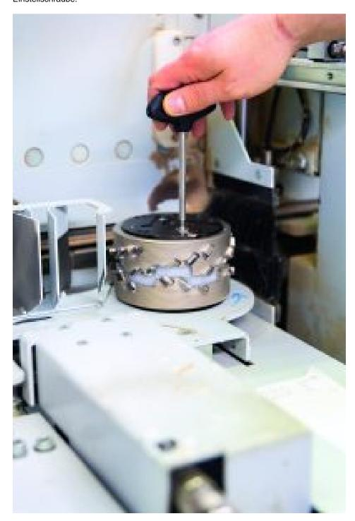
Die beiden Fräserhälften werden durch Drehung mit einem Inbusschlüssel zueinander geführt. Nach nur acht Minuten Maschinenstillstand kann mit einem frisch geschärften Abschnitt der Schneide weiter gefügt werden (Bild: Leuco).
