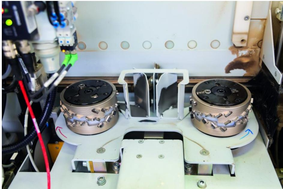
Ein weiterer Vorteil zeigt sich bei einem Konzept mit zwei Werkzeugen im Wechselfräsen: Der Fügefräser im Gegenlauf mit weniger Laufmetern und weniger Abnutzung muss weniger häufig nachgestellt werden (Bild: Leuco).
