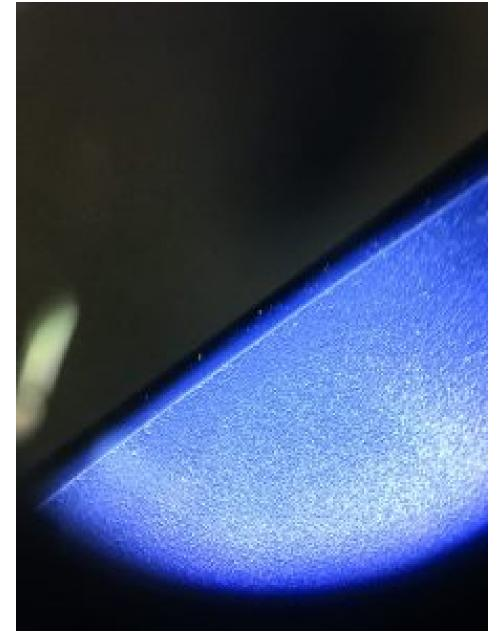
Mit der Lupe wird die Qualität bei Leicht Küchen geprüft. Sie zeigt einen absolut sauberen Übergang von Kante zur Platte ohne Mikrorisse (Bild: Leuco).
