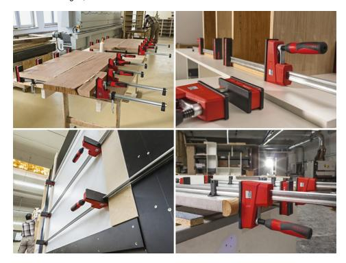
Die Korpuszwingen spannen und spreizen kraftvoll und schonend Werkstücke, auch mit empfindlicher Oberfläche (Bild: Bessey).
