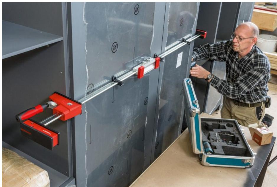
Dank Verlängerung können zwei Zwingen miteinander verbunden werden, um die Spannweite auf bis zu fünf Meter zu vergrößern (Bild: Bessey).
