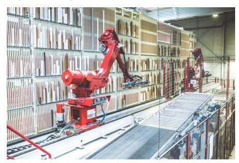
Sortierzellen mit Robotern auf Verfahrachsen und Sortierwand sind eine einfache Lösung für die Bauteil- und Frontensortierung mit hoher Anlagenverfügbarkeit (Bild: Fives Cinetic).
