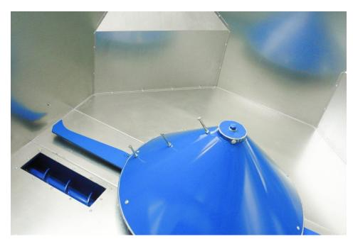
Blick in den Spänesammelbehälter: Das Design verhindert Brückenbildung bei den Spänen und die gefederten Rührarme führen das Material der Schnecke zu, sobald die Füllhöhe erreicht wird (Bild: Höcker Polytechnik).
