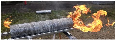
Ein demontiertes Rohrstück zeigt die Dynamik eines Rohrbrandes unter Ausnutzung der Windrichtung auf dem Außenversuchsgelände. Durch den horizontalen Luftstrom, der im laufenden Prozess die pneumatische Förderung liefert, wird der Brand wie bei einem Kamineffekt angefacht. Zur Löschung dieser Brände ist ein geeignetes Löschmedium erforderlich (Bild: T&B electronic).
