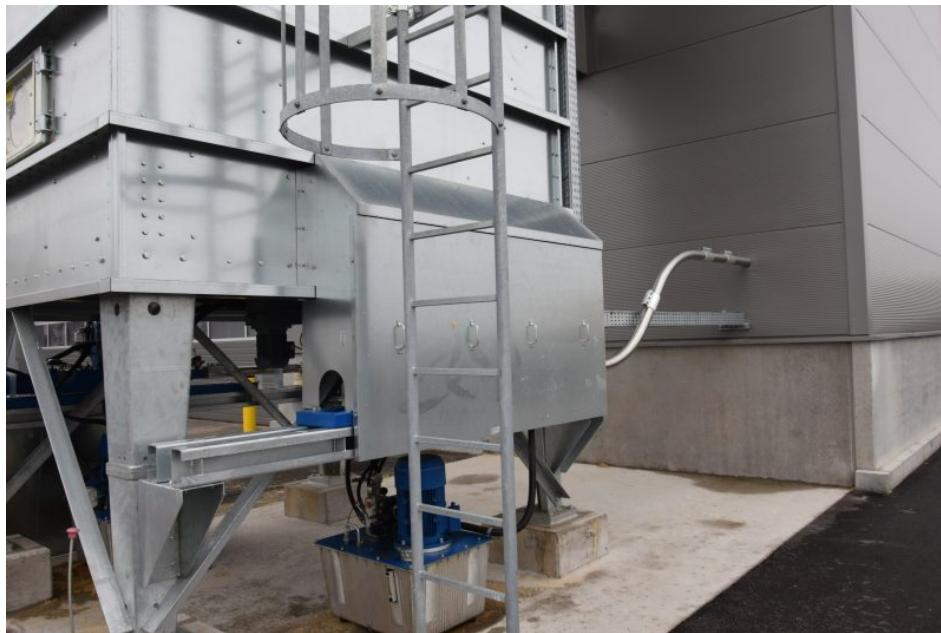
In die Filteranlage integriert sind zwei Brikettpressen, in denen die Späne zu Briketts verpresst werden (Bild: Scheuch Ligno).
