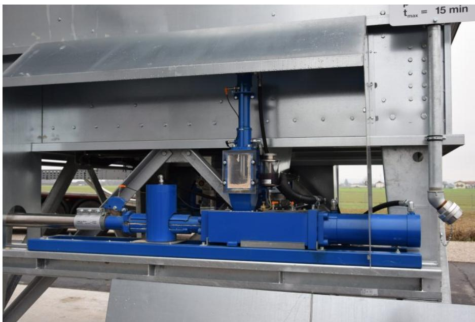
Der Filterbunker dient auch als Bunker für die Brikettpresse (Bild: Scheuch Ligno).
