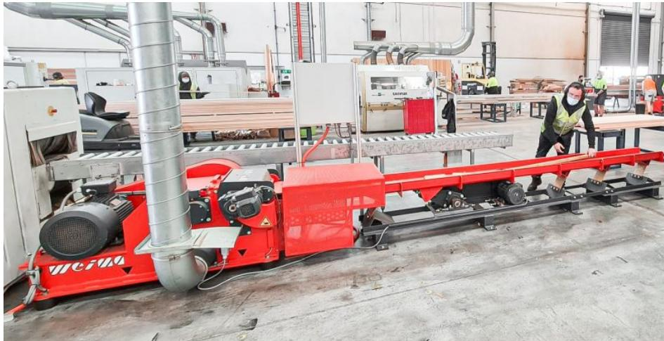
Der Horizontalzerkleinerer in der Holzfertigung von Premier Wood (Bild: Weima).
