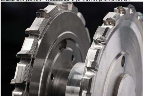
Die neue Version des Zerspaners erlaubt Vorschübe bis 100 m/min bei Platten ab 8 mm Stärke (Bild: Leuco).
