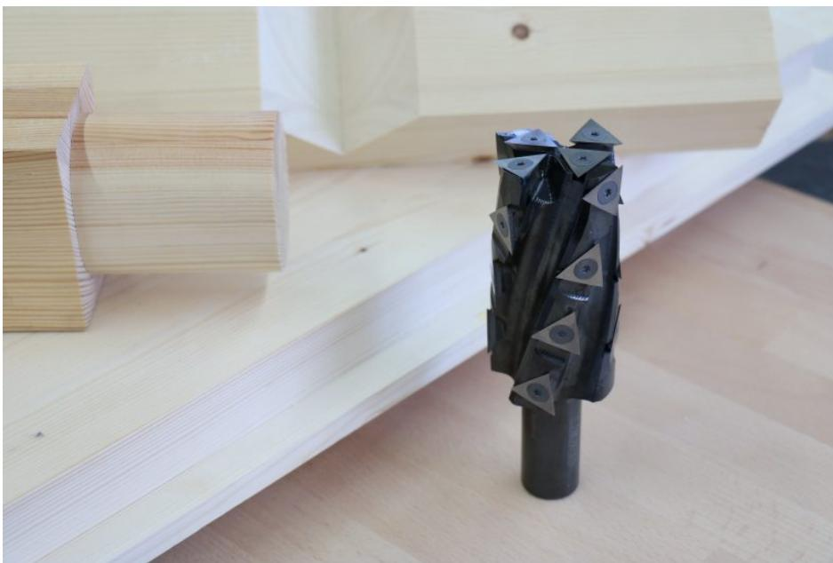
Die Wendeplattenfräser verfügen über eine spezielle Schneidenanordnung und bombierte Dreieck-Wendeplatten (Bild: Leuco).
