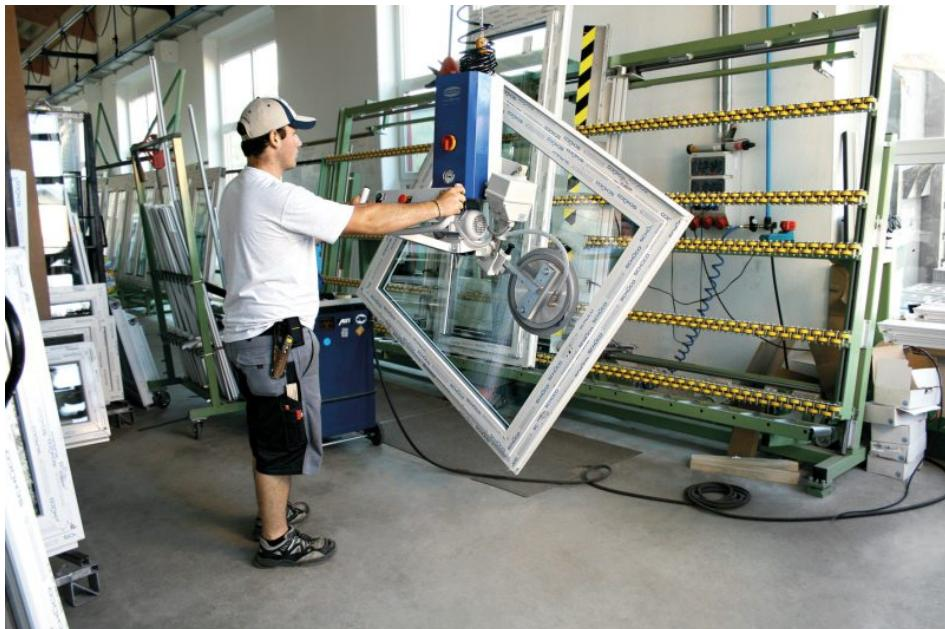
Die UV- und ozonbeständigen Saugplatten sind speziell für Glasoberflächen ausgelegt und sorgen für maximale Haltekräfte (Bild: Schmalz).
