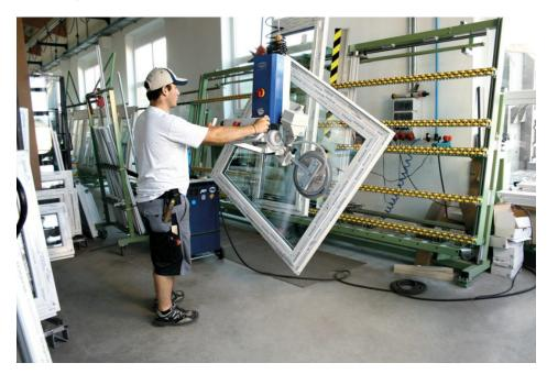
De UV- und ozonbeständigen Saugplatten sind speziell für Glasoberflächen ausgelegt und sorgen für maximale Haltekräfte (Bild: Schmalz).
