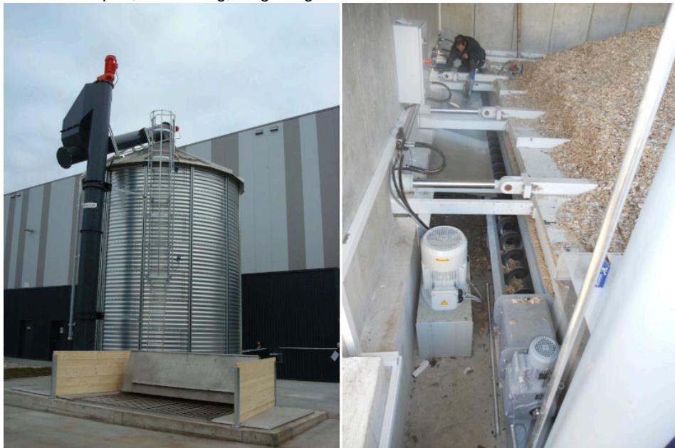
Die achsenlose Fördertechnik wird z. B. für die Zuförderung von Holzvergaseranlagen aus Silos verwendet (Bilder: Wildfellner).
