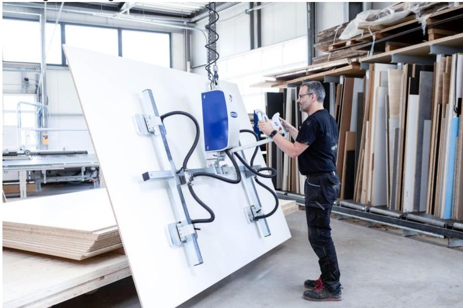
Mit dem Vakuumheber transportiert eine Person Platten aus dem Lager zur Weiterverarbeitung in die Werkstatt (Bild: J. Schmalz).
