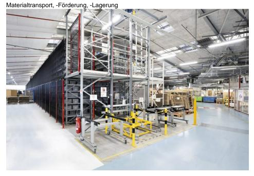
Im Kommissionierlager sorgt ein Shuttlesystem für das schnelle und genaue Handling von Möbelbestandteilen (Bild: Dematic).
