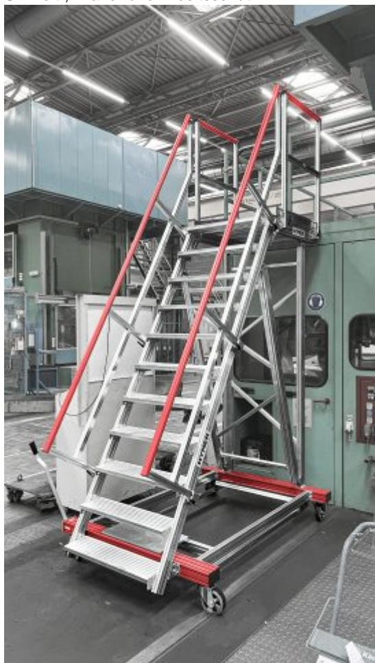
Diese Podeststreppe verschafft sicheren Zugang bei Wartungsarbeiten an einer Hydraulikpresse für Karosserieteile (Bild: Hymer Steigtechnik).
