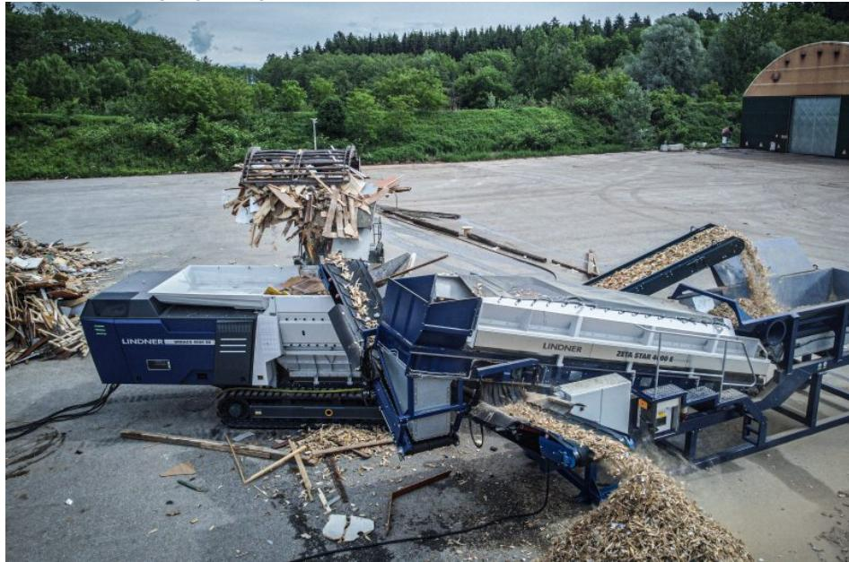
Mobiler Zerkleinerer mit Elektroantrieb und Kettenfahrwerk sowie elektrisch betriebenem Sternsieb (Bild: Lindner).
