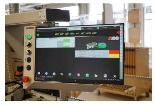
Steuerung einer Umleimmaschine (Bild: Karl Obermann).
