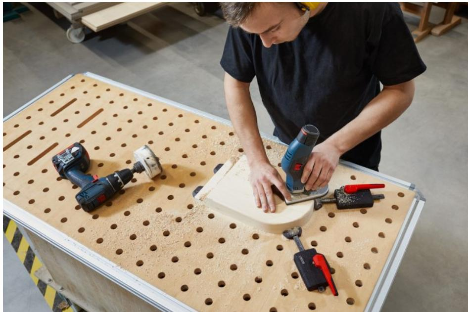
Der neue Waagrecht-Niederzugspanner hält das Werkstück im gespannten Zustand plan auf der Tischfläche (Bild: Bessey).
