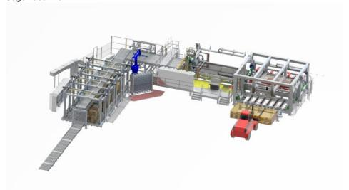
Die Plattenaufteil- und Sortieranlage wird effizient und platzsparend in den Fertigungsprozess integriert (Bild: MHF).
