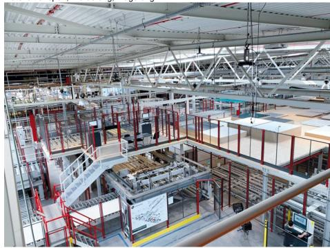
Ein in die Höhe verlegtes Lager hilft, die Platzverhältnisse bestmöglich auszunutzen (Bild: IMA Schelling).
