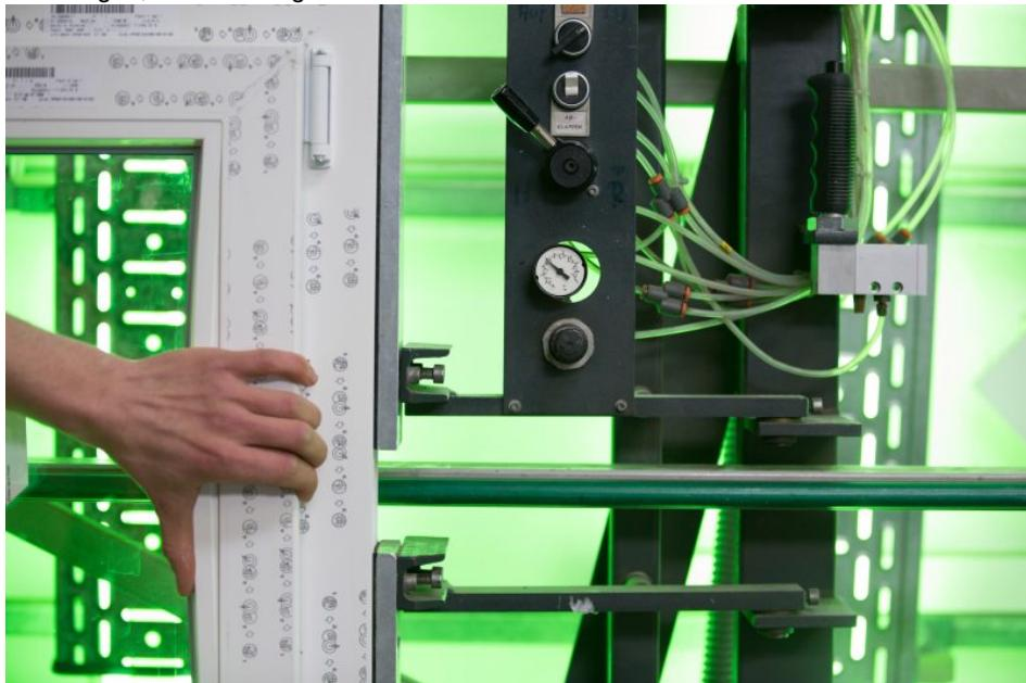
Die Prüfung von Glaseinschlüssen mittels Grünlicht ist Teil der Güteprüfung für Fenster
