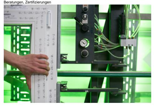
Die Prüfung von Glaseinschlüssen mittels Grünlicht ist Teil der Güteprüfung für Fenster (Bild: Windor).
