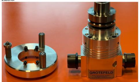
Der Tausch der Antriebsdeckel ist einfach, dazu müssen lediglich 4 Schrauben gelöst werden (Bild: Grotefeld).
