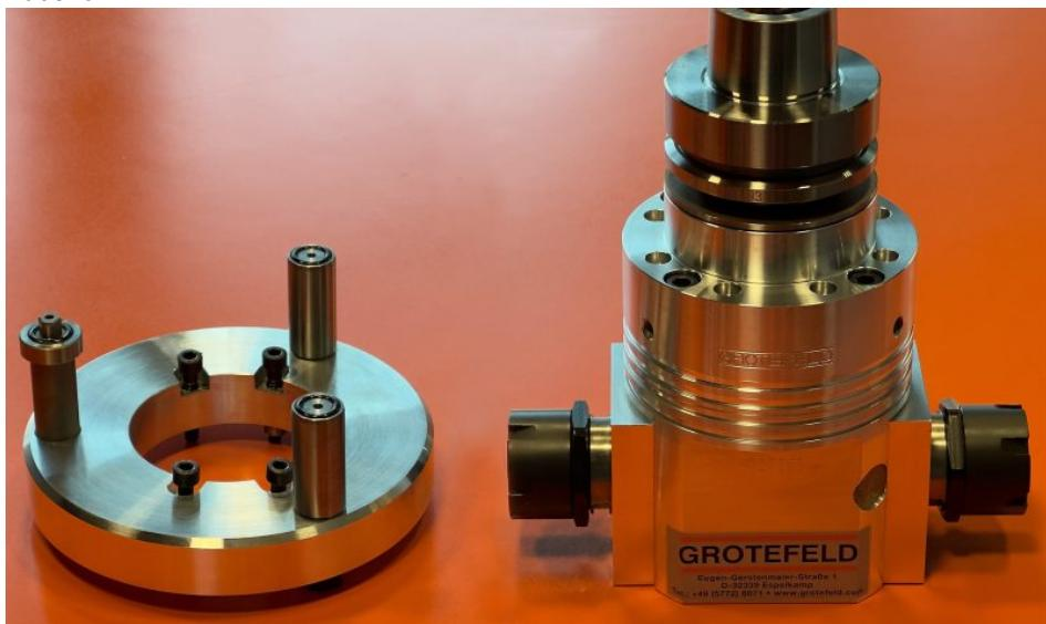
Der Tausch der Antriebsdeckel ist einfach, dazu müssen lediglich 4 Schrauben gelöst werden (Bild: Grotfeld).
