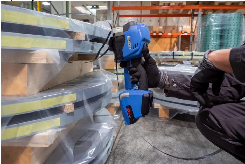
Die Akku-Stahlband-Umreifungsgeräte sind eine sinnvolle Alternative zu pneumatisch betriebenen Geräten (Bilder: Kemapack).
