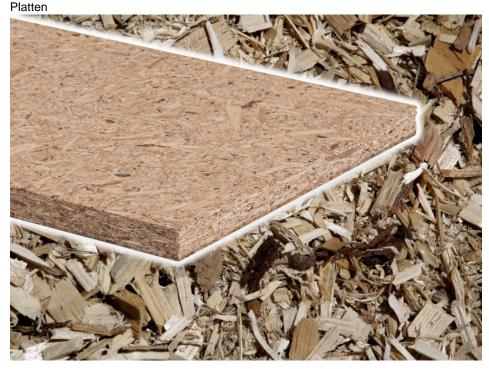
Der Werkstoff enthält Sekundärrohstoff-Recycling-Hackschnitzel und ist formaldehydfrei verleimt (Bilder: Pfleiderer).
